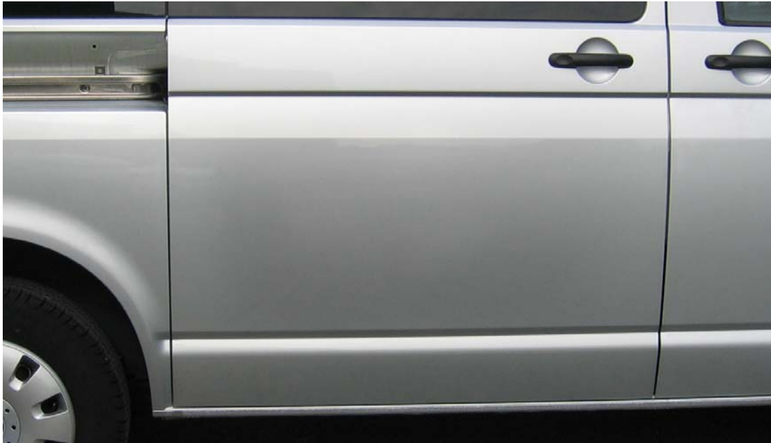
Hier ist die Randzone des Reparaturbereiches gut sichtbar (Quelle Flückiger)
